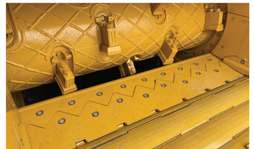
**YUNQUE.** El yunque proporciona la acción de corte entre el tambor triturador o el tambor de virutas, y ayuda a romper el material. El montaje de la estructura del yunque ha sido rediseñada para soportar grandes cargas. Este rediseño facilita el proceso de sustitución del borde de desgaste endurecido, requiriendo menor tiempo de mantenimiento.
