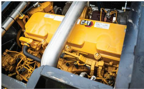
**POTENCIA DEL MOTOR CAT.** El CAT C13B de 536 hp El motor proporciona la potencia necesaria para procesar materiales difíciles, al mismo tiempo que permite servicio y soporte en todo el mundo para la máxima productividad.
