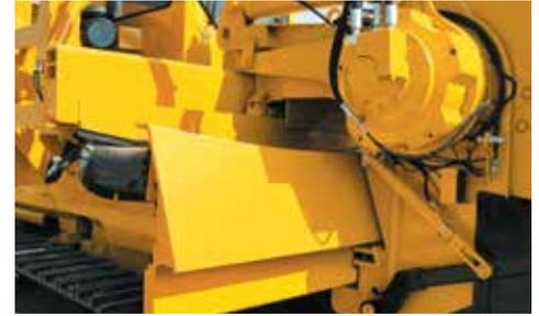
**MOTOR DE TRANSMISIÓN DE ZANJADORA ROTARY POWER.** Un motor de transmisión y eje de cabezal ranurado de Rotary Power generan una velocidad menor y un mayor torque, lo que produce una penetración superior en el suelo y menos desgaste de la cadena para obtener mejores resultados de producción.
