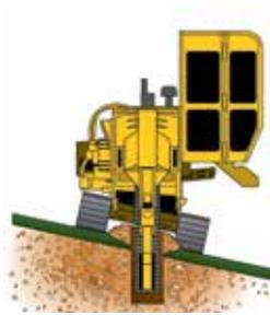
**ORUGA DE INCLINACIÓN AUTOMÁTICA OPCIONAL.** Un chasis de oruga oscilante permite que la oruga siga el contorno del suelo para lograr una zanja vertical en pendientes de hasta 10 grados.
