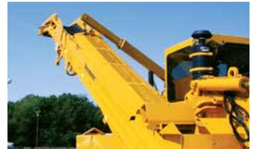
**TRANSPORTADOR DE CARGA OPCIONAL.** Un transportador de carga apilable opcional se almacena más fácilmente y, a diferencia de los modelos de la competencia, no necesita retirarlo para el transporte.
