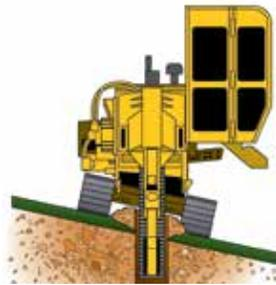
**ORUGA DE INCLINACIÓN AUTOMÁTICA OPCIONAL.** Un chasis de oruga oscilante permite que la oruga siga el contorno del suelo para lograr una zanja vertical en pendientes de hasta 10 grados.
