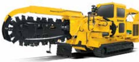
**RENDIMIENTO DE CORTE DESCENTRADO DESLIZANTE EXCLUSIVO.** La T558 es la única zanjadora descentrada deslizante en su clase que puede excavar fuera del ancho de la oruga izquierda: hasta 22,9 cm (9") con una configuración de cadena de 61 cm (24").
