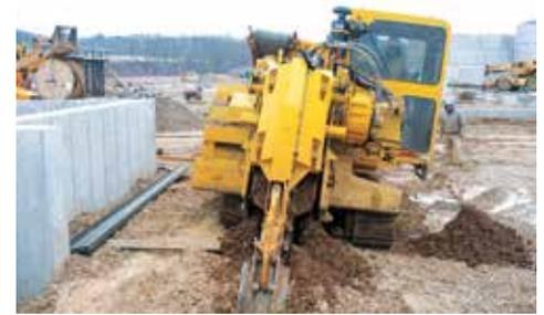
**CABINA DESLIZANTE HORIZONTAL.** Una gran cabina presurizada y con filtrado de aire se desliza 61 cm (24") horizontalmente para brindar una mayor visibilidad al operador.
