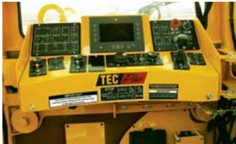
**SISTEMA DE CONTROL ELECTRÓNICO TEC® PLUS.** El sistema de operación se comunica con diversos módulos de control ubicados en toda la máquina para ofrecer datos de rendimiento en tiempo real y capacidades avanzadas de solución de problemas.
