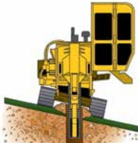
**ORUGA CON INCLINACIÓN AUTOMÁTICA OPCIONAL.** Un chasis de oruga oscilante permite que la oruga siga el contorno del suelo para lograr una zanja vertical en pendientes de hasta 10 grados.
