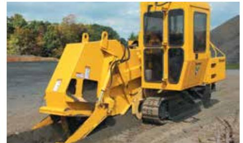
**ACCESORIO DE RUEDA DE CORTE PARA ROCAS HIDROSTÁTICA.** Alimentado por un motor hidrostático, el accesorio de rueda de corte para rocas tiene la capacidad de cortar una zanja de hasta 91,4 cm (36") de profundidad y 15,2 cm (6") de ancho.
