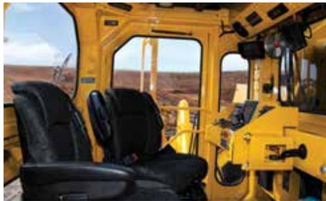
**CABINA CERRADA ELEVADA.** La cabina cuenta con dos asientos con suspensión neumática, dos sistemas de calefacción y enfriamiento autónomos y espuma de atenuación de sonido. También es un módulo de protección contra vuelco (ROPM) y una estructura de protección contra la caída de objetos (FOPS).
