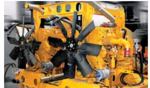
**UN CAT NO ES SUFICIENTE.** La T1655III cuenta con dos motores CAT C18 ACERT, que proporcionan 895 kW (1200 hp) abrirse camino en las condiciones más difíciles.
