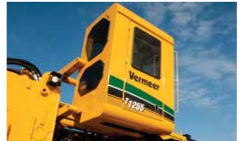
**CABINA CERRADA ELEVADA.** La cabina elevada permite una visibilidad superior y mayor comodidad, gracias al asiento con suspensión neumática. La cabina sellada tiene calefacción y aire acondicionado autónomos con espuma de atenuación de sonido. También es un módulo de protección contra vuelco (ROPM) y proporciona protección contra la caída de objetos (FOPS).
