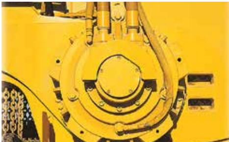
**MOTORES CON EJE DE CABEZAL DOBLE ROTARY POWER Y UN EJE RANURADO.** Los motores Rotary Power dobles proporcionan un rendimiento de corte con torque alto a baja velocidad, lo que ofrece una penetración superior y menos desgaste de la cadena.
