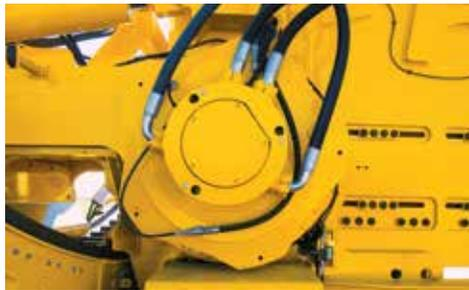
**MOTOR DE TRANSMISIÓN DE ZANJADORA ROTARY POWER.** Un motor de transmisión y eje de cabezal ranurado de Rotary Power generan una velocidad menor y un mayor torque, lo que produce una penetración superior en el suelo y menos desgaste de la cadena para obtener mejores resultados de producción.
