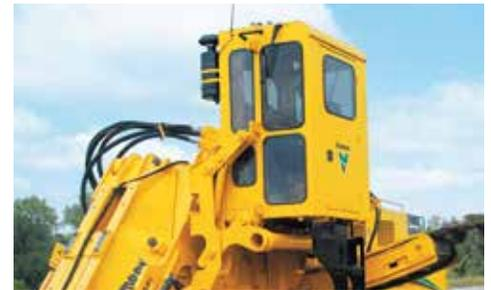
**CABINA ROPM ELEVADA.** La espaciosa cabina elevada de módulo de protección contra vuelcos cuenta con vidrio LEXAN®, aire filtrado y presurizado, calefacción y aire acondicionado. El punto de ventaja de la cabina permite una vista prácticamente sin restricciones del brazo, la zanja y el transportador.
