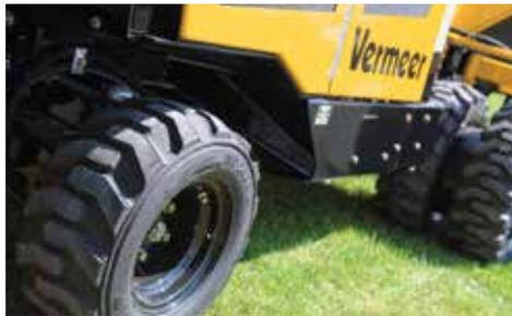
**TODO TERRENO.** Tracción en las cuatro ruedas con bloqueo diferencial. Con potencia y torque transferidos a cada una de las cuatro ruedas, la SC852 es capaz de recorrer terrenos difíciles y desiguales. Con los bloqueos diferenciales desactivados, mejora la maniobrabilidad.
