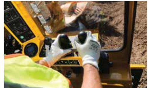
**SISTEMA DE PRESENCIA DEL OPERADOR.** Este sistema del operador fácil de usar está diseñado para proteger al operador y mejorar la seguridad del mismo. Si las manos del operador dejan los controles de la rueda de corte por más de un segundo, esta se desactivará, se detendrá y se apagará la luz indicadora de la rueda de corte.
