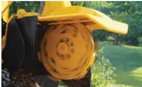
**RUEDA DE CORTE.** A medida que el brazo baja de la posición completamente elevada, la rueda de corte se aleja de la máquina, con lo que aumenta el ancho de corte máximo, logrando una altura de corte de 78,7 cm (31") sobre la superficie y de 63,5 cm (25") por debajo del nivel de la superficie.
