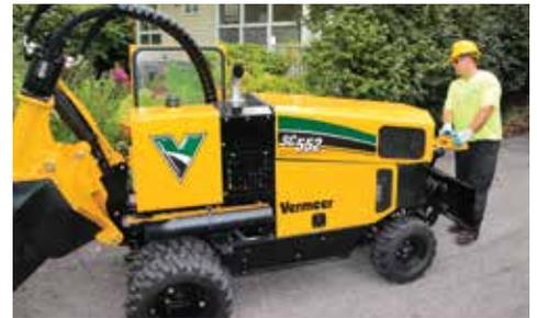
**ESTACIÓN DE CONTROL AUXILIAR.** En lugares de trabajo angostos que restrinjan el uso de la estación de control principal, el operador puede controlar el desplazamiento y las funciones de dirección desde esta estación plegable montada en el extremo delantero de la máquina.
