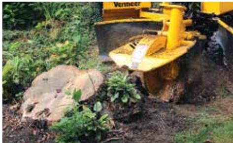
**MÁXIMO ANCHO DE CORTE.** La SC552 reduce el tiempo que el operador usa en reposicionar la máquina, con una altura de corte de 78,7 cm (31") sobre la superficie 63,5 cm (25") por debajo del nivel de la superficie. La dimensión de corte en línea recta permite que el operador corte un tocón de 1,8 m (6') sin reposicionar la máquina.
