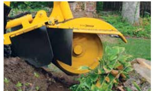
**OPERACIÓN SIN PROBLEMAS.** El exclusivo **SISTEMA DE CONTROL SmartSweep™** monitorea la carga del motor y proporciona una retroalimentación continua, lo que tiene como resultado una velocidad de barrido suave y constante de la rueda de corte.
