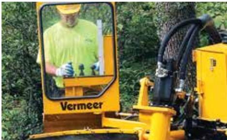
**SISTEMA DE PRESENCIA DEL OPERADOR.** Este sistema del operador fácil de usar está diseñado para proteger al operador y mejorar la seguridad del mismo. Si las manos del operador dejan los controles por más de un segundo, se desactivará la rueda de corte, se detendrá y se apagará la luz indicadora de la rueda de corte.
