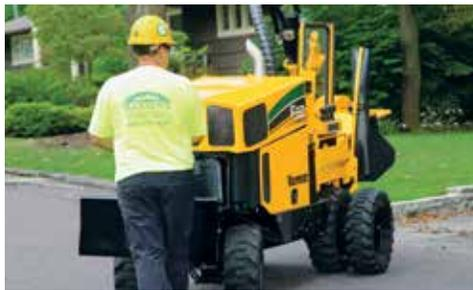
**TRACCIÓN EN LAS CUATRO RUEDAS CON BLOQUEO DIFERENCIAL.** Con potencia y torque transferidos a cada una de las cuatro ruedas, la SC552 es capaz de recorrer terrenos difíciles donde el operador puede activar los bloqueos diferenciales para mantener la potencia de tracción en las rutas de tracción desigual de las ruedas.
