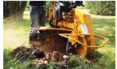
**SISTEMA DE CONTROL AUTOSWEEP®.** Cuando está equipado, el sistema AutoSweep monitorea la velocidad del motor y ajusta automáticamente la velocidad de barrido de la rueda de corte y está diseñado para reducir la tensión en el motor y el grupo de engranajes conductores y la tensión estructural.
