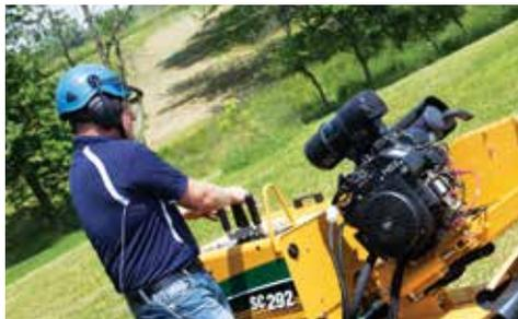
**DESPLAZAMIENTO DE DOS VELOCIDADES.** El operador puede elegir un ajuste de velocidad de desplazamiento de rango alto o rango bajo de 0 a 40,5 m/min (0 a 133 fpm) para mover rápidamente la máquina, o bien, puede elegir una velocidad más lenta cuando esté cerca de un tocón con el ajuste de rango bajo de 0 a 20,1 m/min (0 a 66 fpm).
