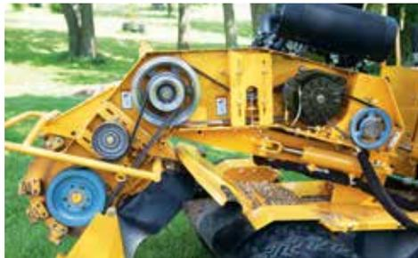
**MANTENIMIENTO CÓMODO DE LA BANDA.** Se puede realizar mantenimiento a las bandas en la SC292 desde un lado de la máquina, gracias a las bandas de transmisión que se pueden ajustar con poleas de guía móviles. Además, cada conjunto de bandas se puede ajustar de manera independiente, sin afectar el ajuste de otras correas.
