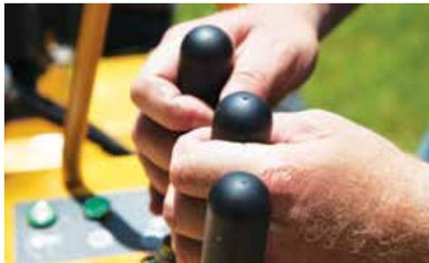
**SISTEMA DE PRESENCIA DEL OPERADOR.** Las manillas de control de oscilación del brazo, elevación y bajada del brazo y propulsión de la máquina están equipadas con un diseño de manilla con presencia del operador que proporciona una capacidad de detección de capacitancia. Este sistema de presencia del operador fácil de usar está diseñado para proteger al operador y mejorar la seguridad del mismo.
