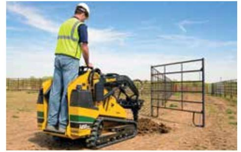
**UNA PLATAFORMA SEGURA** El operador se mantiene alejado del lodo. El sistema integrado de presencia del operador suspende el desplazamiento y el movimiento del brazo o cucharón cuando el operador se sale de la plataforma.
