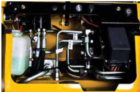
**LA FACILIDAD DE MANTENIMIENTO ES LA CLAVE.** Acceda al radiador, a los componentes eléctricos y a las válvulas hidráulicas a través del panel posterior. ¿Necesita acceder al motor? Simplemente levante la carcasa lateral para un mantenimiento fácil.
