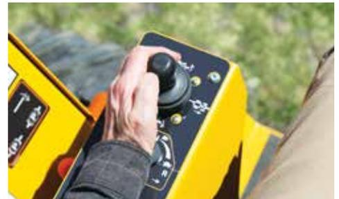
**EN CONTROL.** Los controles cómodamente ubicados que se manejan con la punta del dedo minimizan la extensión del operador y permiten que el operador se mantenga cómodo mientras realiza prolongadas instalaciones de fibra óptica, servicios, gas y eléctricas.
