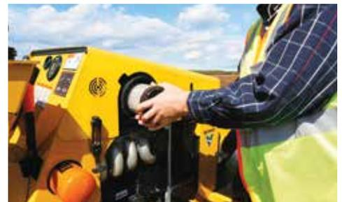
**FACILIDAD DE MANTENIMIENTO.** El acceso a los filtros de aire, aceite del motor e hidráulico no requiere el retiro de las protecciones, lo que hace que el servicio y el mantenimiento preventivo de la máquina sea más eficiente.
