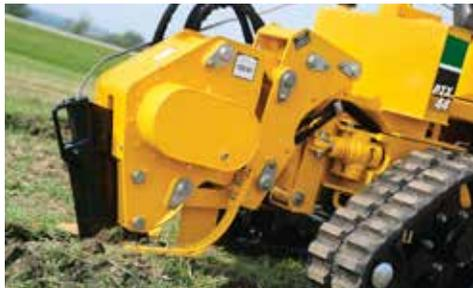
**MÁXIMA PRODUCTIVIDAD.** El arado dedicado tiene una profundidad de instalación máxima de 61 cm (24"), mientras que el accesorio de zanjadora opcional tiene una profundidad de zanjado máxima de 106,7 cm (42") y un ancho de 15,2 cm (6").
