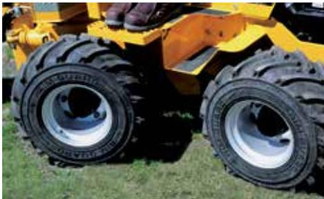
**DISEÑO ARTICULADO.** El PTX44 con articulación central oscila en el punto de articulación, lo que proporciona un rendimiento incomparable en terrenos desiguales.
