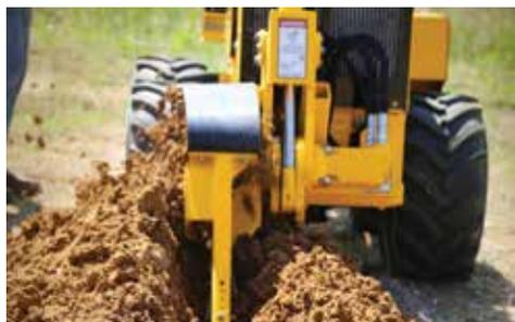
**VERSATILIDAD DE LA MÁQUINA.** El versátil PTX40, utilizado para instalaciones de riego y servicios públicos, es un arado/zanjadora con una profundidad de arado dedicado de hasta 61 cm (24"), una profundidad de zanjado de hasta 106,7 cm (42") y un ancho de 10,2 a 15,2 cm (4 a 6"). El accesorio de perforación opcional tiene un torque máximo de 670 Nm (494 ft-lb).
