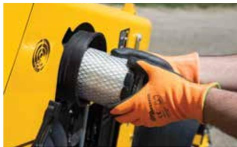
**FACILIDAD DE MANTENIMIENTO.** El acceso a los puntos de mantenimiento necesarios, como los filtros de combustible, aceite hidráulico, aceite del motor y aire, no requiere que se retiren protecciones, lo que aumenta la eficiencia del mantenimiento de la máquina y simplifica el mantenimiento diario.
