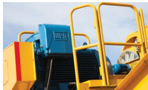
**MOTORES ELÉCTRICOS.** Equipado con un motor eléctrico enfriado por aire completamente cerrado WEG de 373 kW (500 hp) para activar la trituradora. Un motor eléctrico separado de 37,3 kW (50 hp) activa la bomba para los circuitos hidráulicos, mientras que un motor eléctrico de 1,5 kW (2 hp) activa el ventilador para enfriar el sistema hidráulico.
