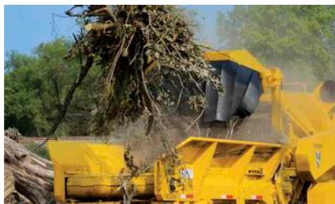
**MESA DE ALIMENTACIÓN ANCHA.** Una mesa de alimentación ancha de 152,4 cm (60") con paredes laterales acampanadas puede admitir un gran volumen de material.
