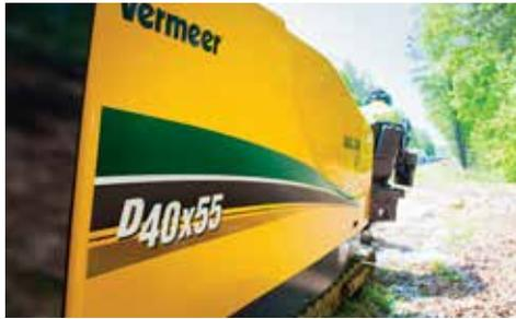
**RENDIMIENTO PREMIUM.** Con un empuje y tiro de 177,9 kN (40.000 lb) y 7457 Nm (5500 ft-lb) de torque la D40x55 S3 ofrece un aumento de 10 % en empuje y rotación sobre su antecesora, la D36x50 Serie II, lo que maximiza la productividad.
