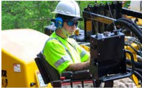
**REDUCCIÓN SIGNIFICATIVA DEL SONIDO.** Con un nivel de potencia de sonido garantizado de 104 dB(A) y una clasificación para el oído del operador de 82,9 dB(A), [clasificación en la cabina de 75,7 dB(A)], la D40x55 S3 es significativamente más silenciosa que su antecesora, lo que contribuye a un entorno de trabajo más silencioso, con menos molestias para el vecindario y una comunicación más fácil entre el personal.
