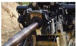
PRENSA. La prensa deslizante se mueve 89,9 cm (35.4") para que los operadores coloquen la prensa en una posición para lograr la máxima eficiencia al momento de escariar y extraer producto.
