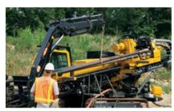
GRÚA ESTILO BRAZO ARTICULADO. La grúa estilo brazo articulado opcional montada en uno de los lados del anclaje base puede maniobrar herramientas pesadas, para disminuir la necesidad de equipo de apoyo.
