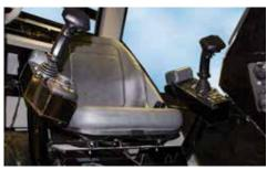
CONTROLES COMUNES. La D220x300 S3 comparte controles comunes con otras perforadoras de la línea Navigator, lo que puede disminuir el tiempo de capacitación del operador y permitir puestas en marcha más rápidas.
