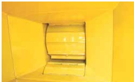
**DOS RODILLOS DE ALIMENTACIÓN HORIZONTALES.** El rodillo de alimentación inferior está descentrado del rodillo de alimentación superior para garantizar que el material a máxima capacidad sea fácilmente enviado a la astilladora.
