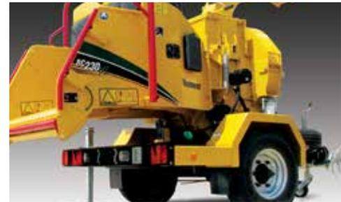
**ALTO DESPEJE DEL CHASIS.** 36 cm (14,2") bajo el chasis y 26 cm (10,2") bajo el eje que permite que la astilladora sea usada en todo terreno sin riesgo de que los residuos del suelo queden atrapados y provoquen daños o problemas con el remolque.
